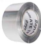
Bei Kunststoff- und Edelstahlrohren wird das Frostschutzband vollflächig der Länge nach mit dem Aluminium-Klebeband ATE-180 überklebt.
